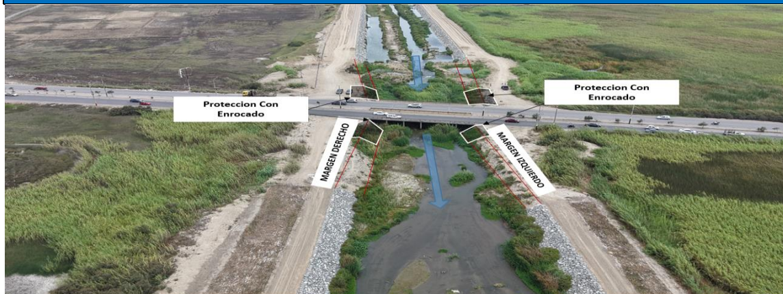
FIGURA N°01: Vista desde el dron Sobre el Puente Pardo, se aprecia el cauce del río Lacramarca. La meta física consta de la descolmatación y conformación de dique con material propio en ambos márgenes del Río Lacramarca en una longitud total de 180 ml aproximadamente.
